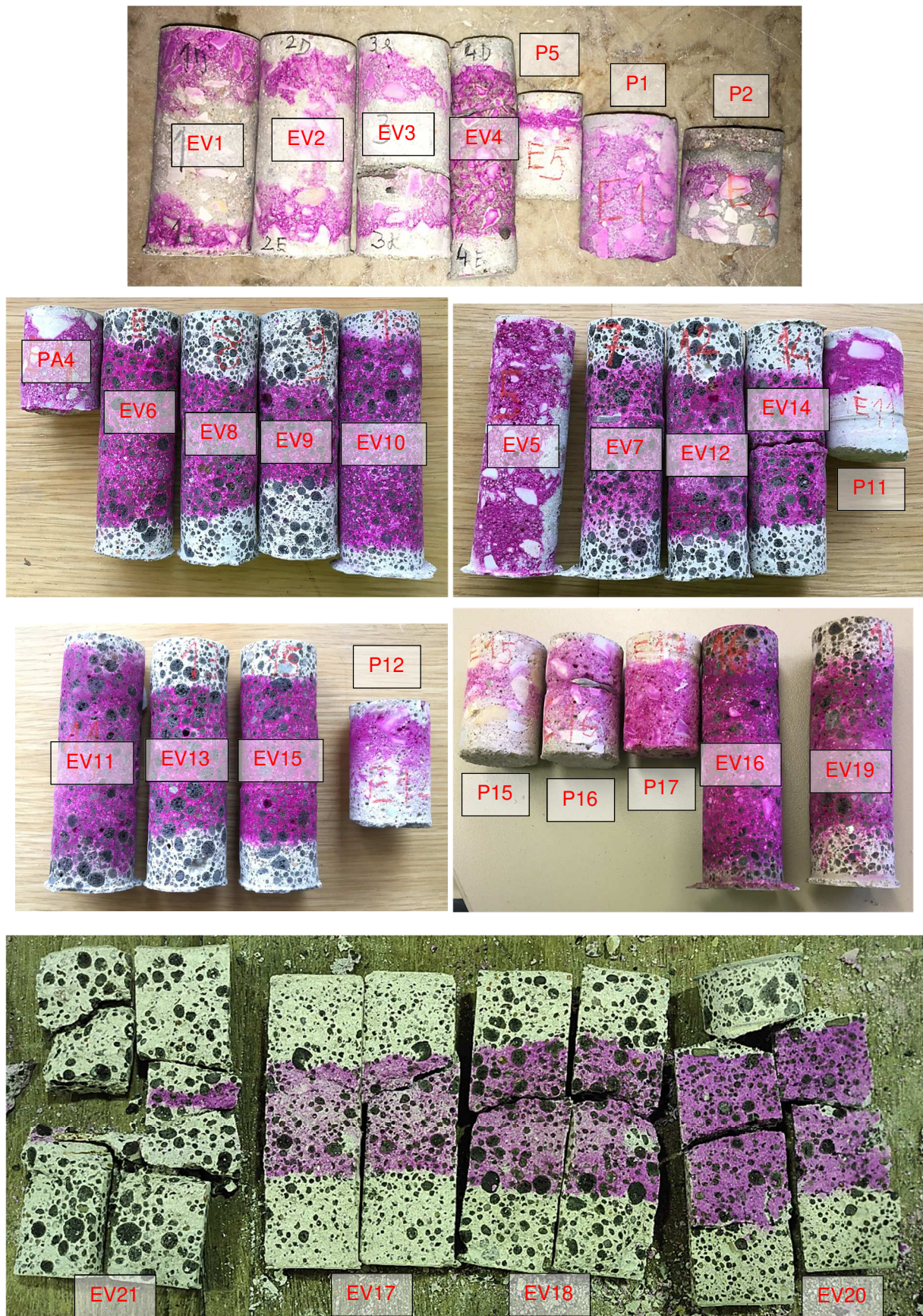
Figura 4.5 – Carotes de betão extraídas dos elementos
